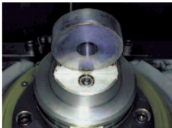
Das Gerüst wird aus einem runden Titanblock herausgefräst.
